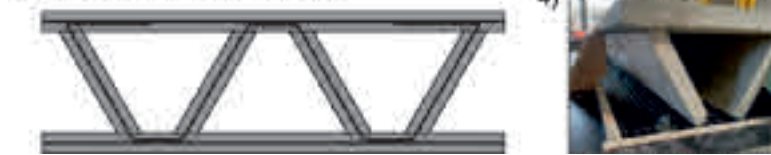
Abb. 2: Herstellung der Deckenelemente mit Falten durch thermoplastisches Umformen der zunächst noch offenen Carbonbewehrung-Zwischenstege
